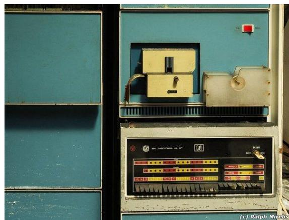
На снимке слева показана перфорированная карта (на БЭСМ-6), справа: вид панели ЭВМ «Электроника 100-25» с загрузкой и передачей информации путем перфорирования на бумажной ленте.
