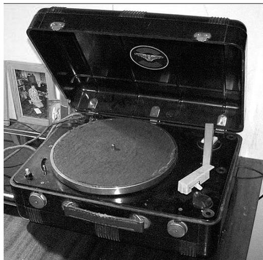
Чтобы послушать пластинки, я использовал патефон с корпусом из эбонита и звукоснимателем с корундовыми иглами. Усилителем служил радиоприёмник «Балтика» с «зелёным огоньком». Лампа изменяла интенсивность света в зависимости от настройки. Приёмник с 1960 по 1973 гг. ни разу не ломался. Электронные лампы делались в 40-е годы в Австрии (мы покупали трофейные). Для новых пластинок я приделал пластиковый (белый) звукосниматель с пьезо-датчиком (правый снимок).
