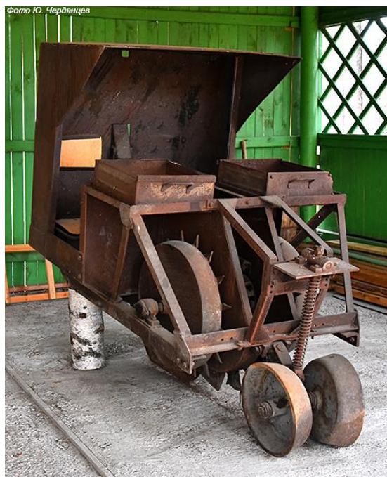
Лесопосадочная машина ЛМД-1 Обслуживающий персонал: • Тракторист – 1 • Сажальщик – 2 • Оправщик – 1 Производительность – 1,5 км. в час; – 3-5га в смену.
