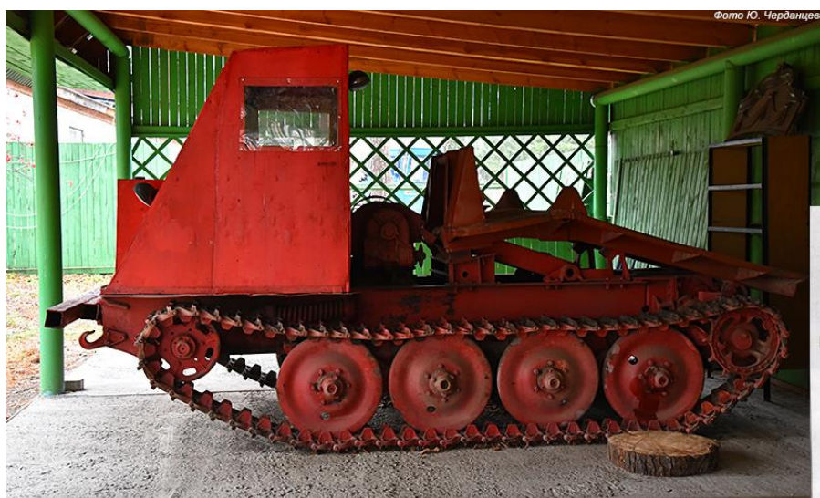
Трактор дизельный трелевочный ТДТ-40 Выпуска Минского тракторного завода 1958 года. Работал в Кенгинском лесничестве Бакчарского лесхоза до 1975 года. Восстановлен в 2007-2014 годах Томским УФСИНОМ и Томским музеем леса.
